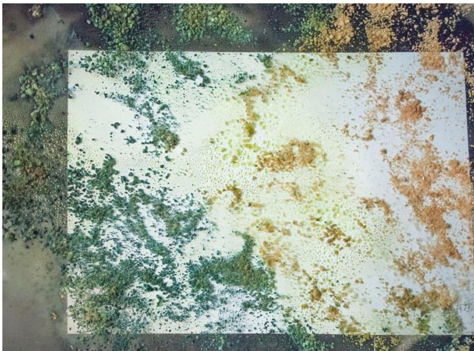
Abbildung 12: Salzpflanze aus den Experimenten 3.6a und 3.6b nach dem Besprühen mit einer Kaliumhexacyanoferrat-(III)-Lösung zum Nachweis von Eisen-(II). Der rechte Teil war mit Aluminium-Folie vor Bestrahlung geschützt und zeigt kein Eisen-(II)
